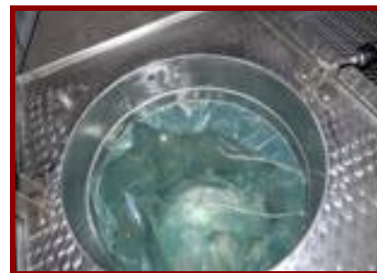
▲ Foto 5 - Distillatore aperto con in evidenza il sacchetto interno
