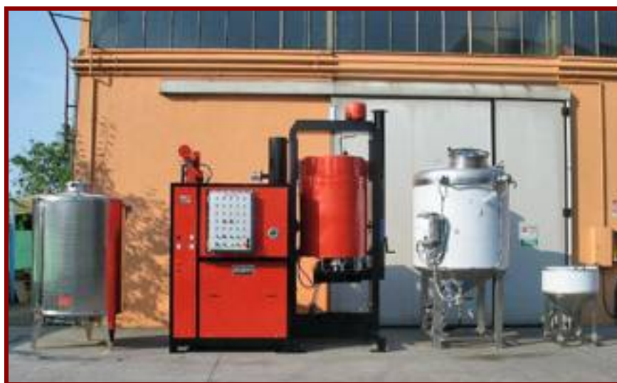
▲ Foto 2 - Esempio di installazione di distillatore per solventi
