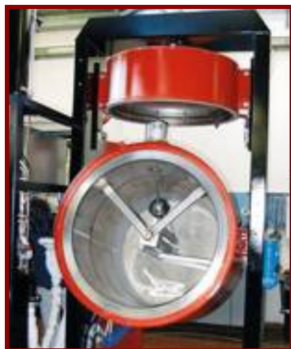
▲ Foto 3 - Esempio di bollitore aperto
