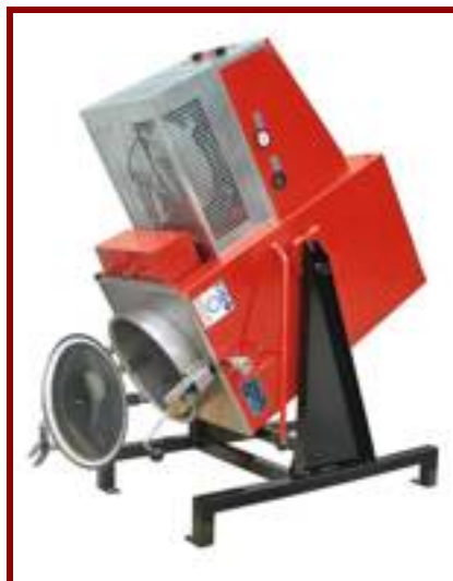
▲ Foto 6 - Sistema basculante che consente di ruotare il distillatore
