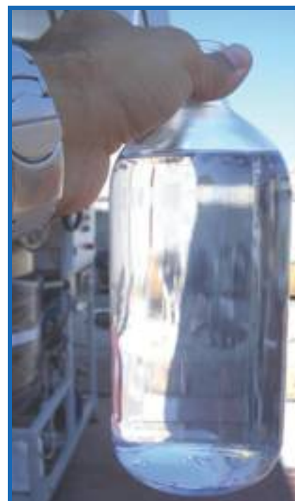
▲ Foto 8 - Campione di distillato in uscita dall'evaporatore
