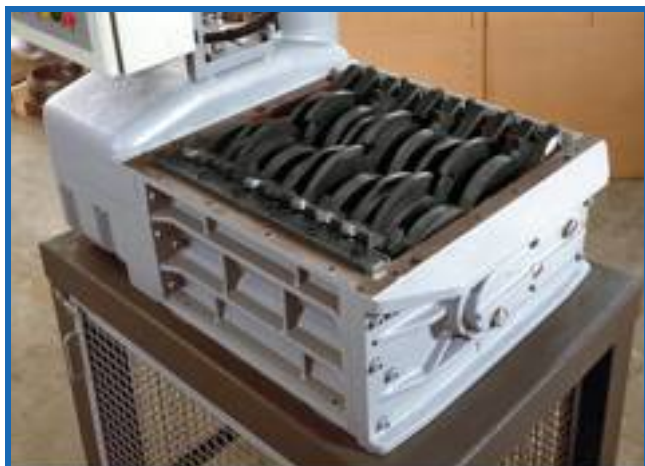
▲ Foto 6 - Impianto di triturazione dei rifiuti - particolare del corpo macinante
