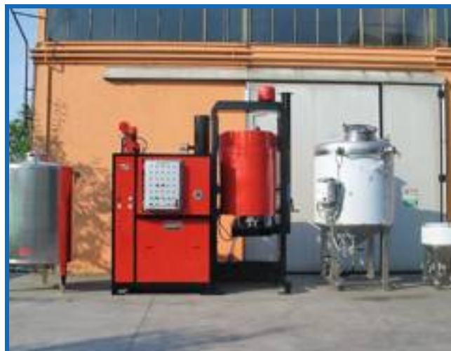
▲ Foto 7 - Esempio di linea di distillazione di solventi
