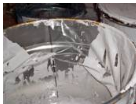
Pellicola interna ai fusti contenenti il gelcoat (Foto D)
