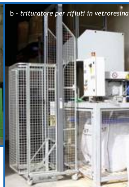
▲ Foto 5 - Esempi di installazione di linee di triturazione
