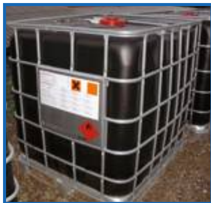
▲ Foto 4 - Cisterne da 1.000 L in PEHD restituibili al fornitore sulla base di specifici accordi
